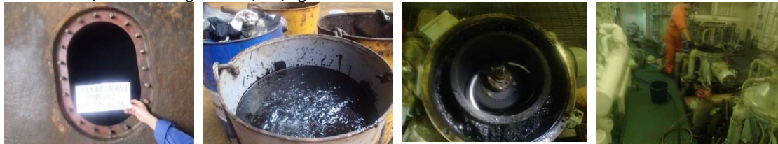
Hình 1. Ảnh hưởng của lớp keo/cặn khi kết MGO bị lẫn HFO trên tàu Ratu Tembaga tháng 8 năm 2014
