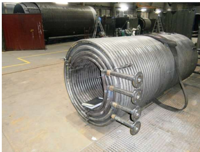
Hình 3. Cụm ống dầu nhiệt
