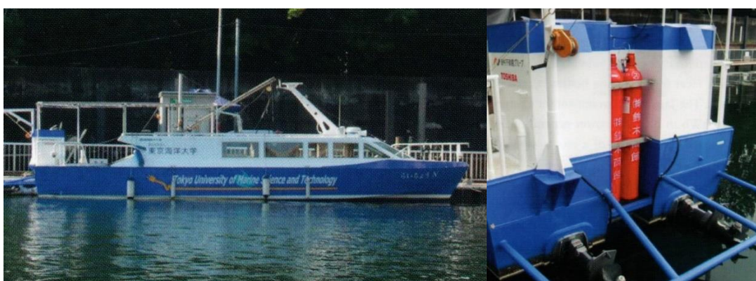
Hình 2.2. Tàu thí nghiệm chuyên chở hydrogen “Raicho N”
