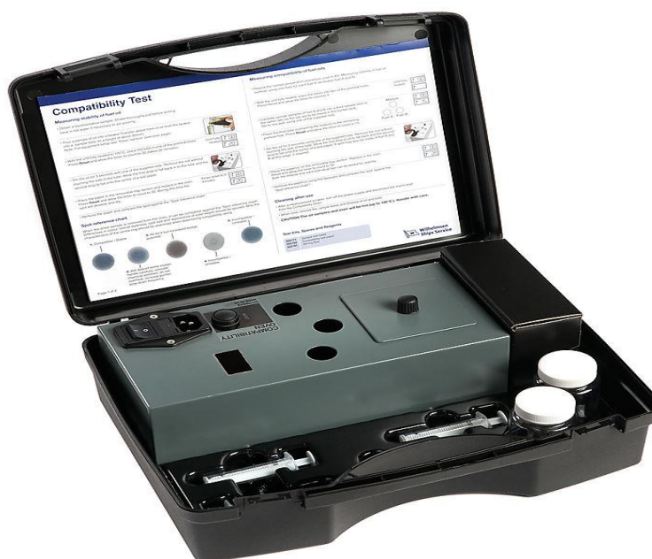
Hình 3. Thiết bị kiểm tra độ tương thích của nhiên liệu
