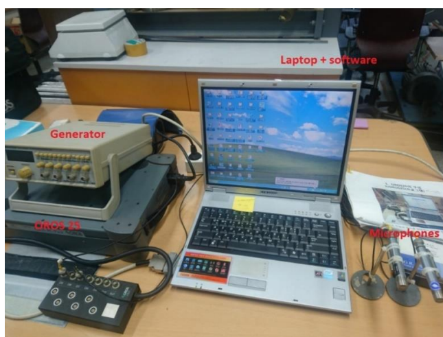
Hình 3. Thiết bị đo và phân tích âm thanh
