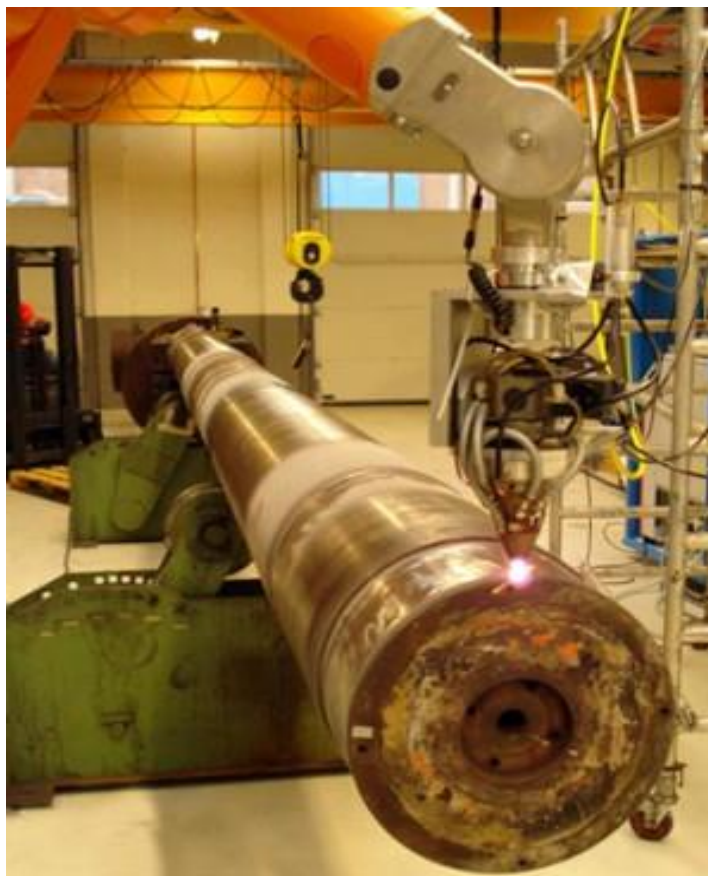
Hình 5. Ứng dụng phun phủ bằng Laser scadding phục hồi bề mặt bị biến dạng của trục.
