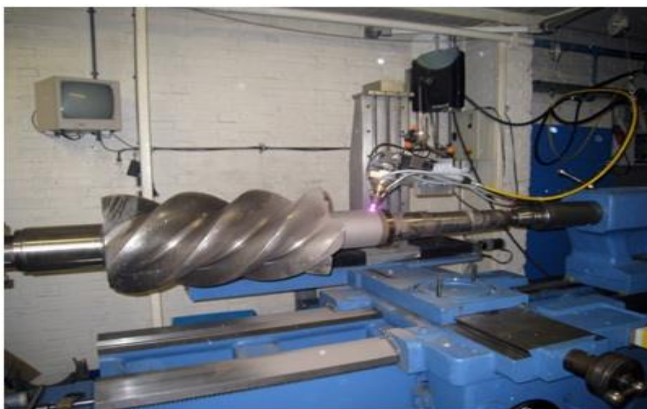
Hình 4. Ứng dụng phun phủ bằng Laser scadding phục hồi bề mặt bị mài mòn của trục vít.
