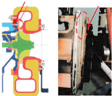
Hình 5. Vòng phun bị ép và vỏ khí xả bị biến dạng vì nhiệt.
