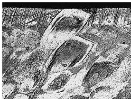
Hình 6. Những vết lõm "thép dẹt" trên bề mặt bảng clape
