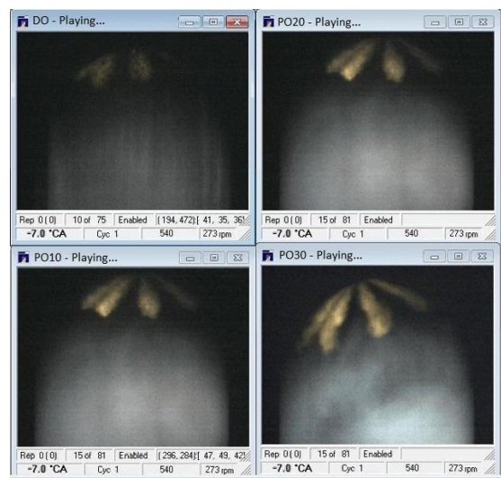
Hình 3. Hình ảnh nhiên liệu hòa trộn, cháy ở -7 độ GQTK trước ĐCT, 273 v/p
