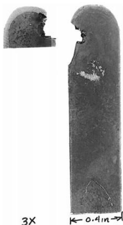
Hình 5. Hình ảnh clape bị rỗ
