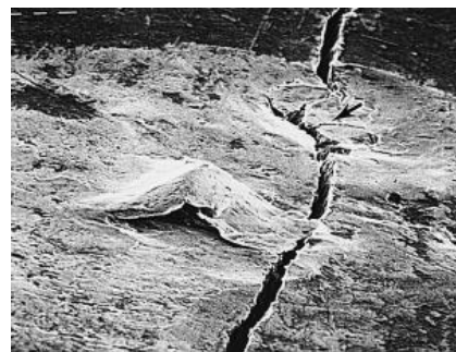
Hình 7. Vết nứt và lõm xuất hiện trên clape
