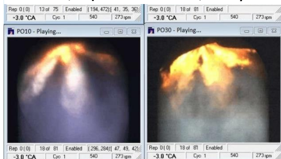
Hình 4. Hình ảnh nhiên liệu cháy ở -3 độ GQTK trước ĐCT, 273 v/p
