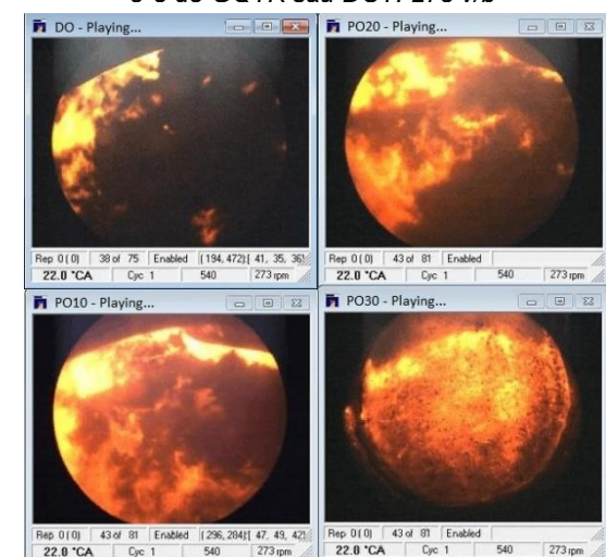
Hình 7. Hình ảnh nhiên liệu cháy ở 22 độ GQTK sau ĐCT, 273 v/p
