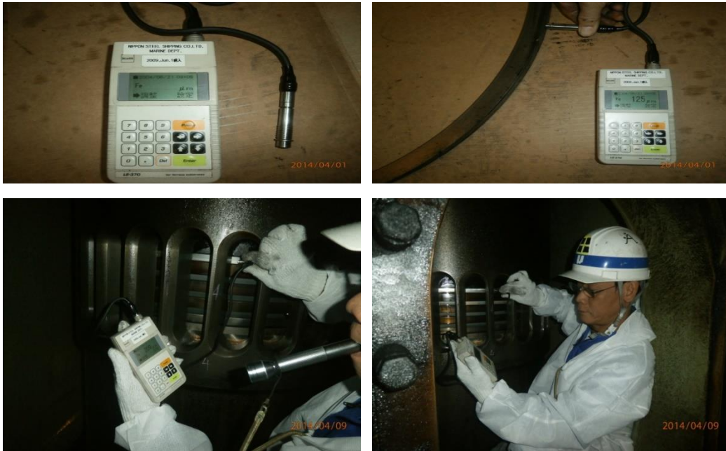
Hình 8: Thiết bị và phương pháp đo chiều dày lớp mạ cứng trên xéc-măng 2.1.1. Vị trí đo độ dày lớp mạ cứng
