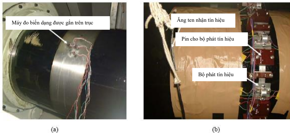
Hình 5: Gắn máy đo biến dạng và lắp đặt các thành phần của hệ thống truyền tín hiệu
